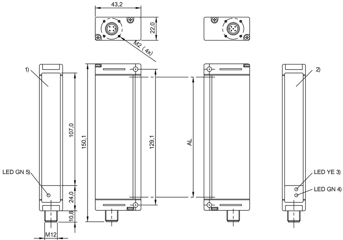
1) 有效面, 2) 有效面, 3) 输出功能, 4) 稳定性/故障, 5) 工作电压
